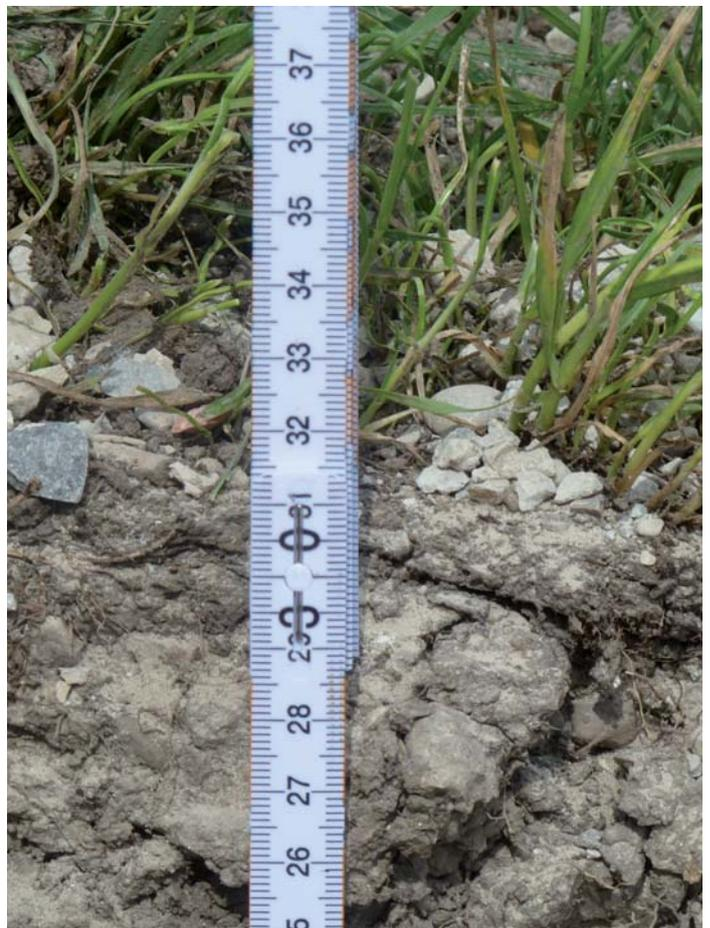
Abb. OK Frostschutzschicht -30cm 18.5.2016; 14:52
