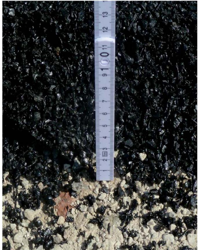
Abb. Fallschutzbelag Dicke 7cm 07.6.2016; 09:14
